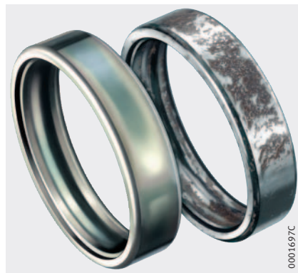
图 4 · 经过盐雾试验的带涂层和不带涂层轴承
