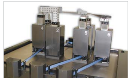
能精确测量元器件的通用元器件抓取设备
